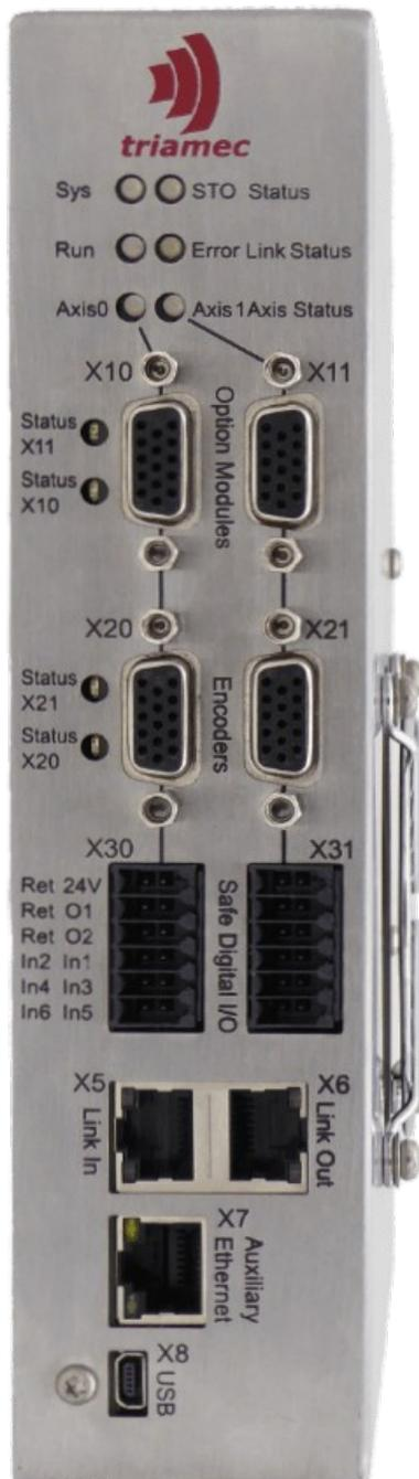
Die TSD Serie besteht aus zwei kompletten Servoantrieben in einem Gehäuse.
